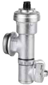
Terminale per collettori con valvola sfogo aria automatica e scarico girevole.
