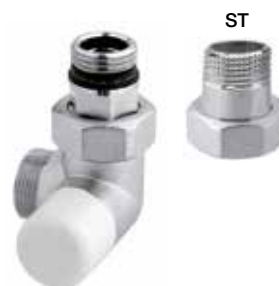
Detentore cromato ad angolo versione destra. Attacco tubo rame, plastica e multistrato. Chromium-plated right angle lockshield. Connection for copper, plastic and multilayer pipe.
