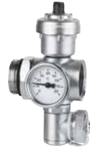
Gruppo premontato per collettori con valvola sfogo aria automatica, scarico girevole e termometro 0°÷80°C.
