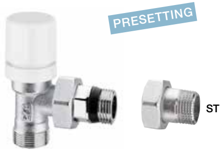
Valvola a squadra cromata termostattizzabile con preregolazione. Attacco tubo rame, plastica e multistrato.
