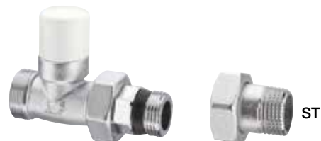
Detentore diritto cromato. Attacco tubo rame, plastica e multistrato. Chromium-plated straight lockshield. Connection for copper, plastic and multilayer pipe.
