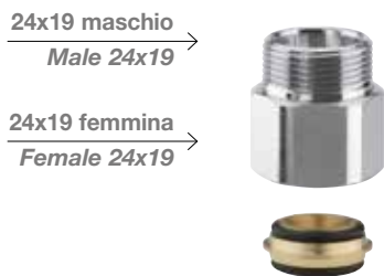
Prolunga cromata filetto 24x19 M/F con ogiva di tenuta. Attacco tubo rame, plastica e multistrato. Chromium fitting thread 24x19 M/F with seal. Connection for copper, plastic and multilayer pipe.
