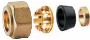
Raccordo a compressione per tubo rame monocono in gomma. Calotta filetto 24x19 gialla.
