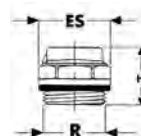
Valvola di sfogo aria manuale per radiatori con possibilità di rotazione dello scarico. Filetto tenuta O-ring.
