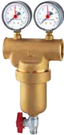
Filtro autopulente F/F, (PN 25) filtrazione 100 micron, due manometri e rubinetto di scarico.
